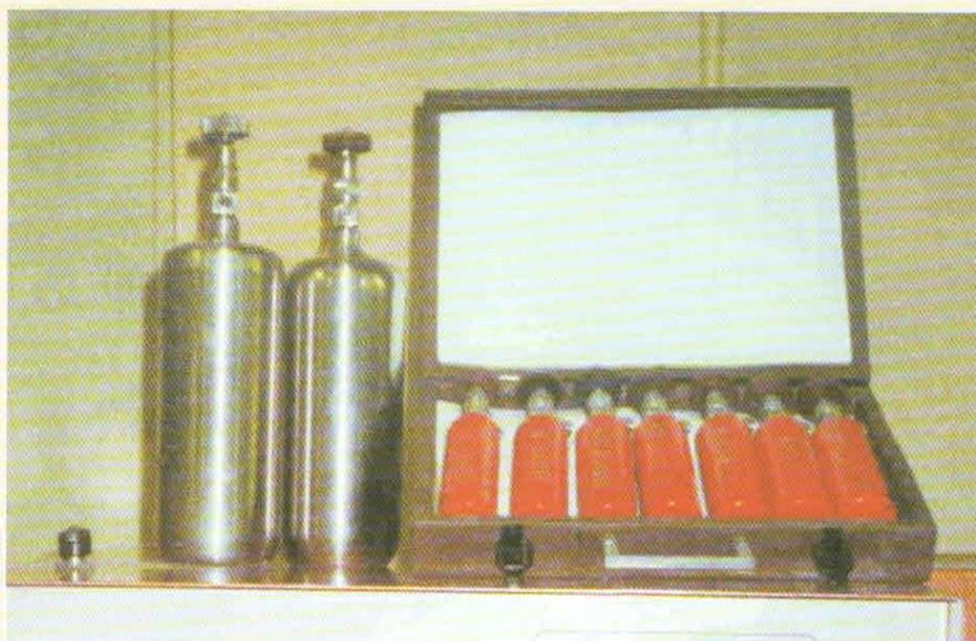
метил- и этилмеркаптанов) и неорганических соединений в азоте, гелии, аргоне, воздухе и в других газах. Диапазон объемной доли компонентов в смеси – (0,0005-99)%. Смеси выпускаются в 1, 2, 4, 5, 10, 40-литровых баллонах (ВНИИУС или Заказчика).
